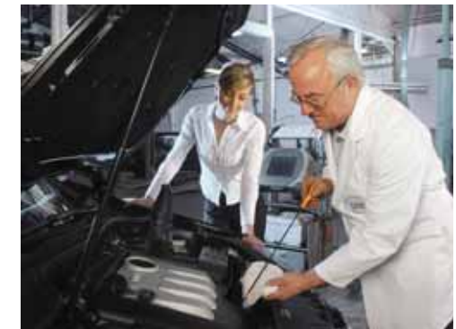
Auch der Ölstand sollte vor Beginn der Sommersaison überprüft und eventuell das Öl gewechselt werden. Foto: ProMotor
